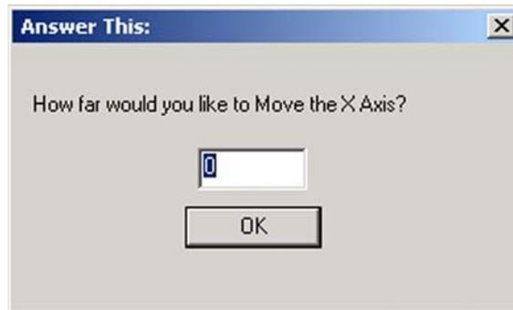
最終的に、移動の後に動かされた正確な距離を測定して、あなたが入るようにながされる、図5-15に示されるように。これは、あなたのマシン軸のUnitあたりの実際のStepsについて計算するのに使用される。セクション5.5.4 軸の旅行を測定する方法を説明する。
