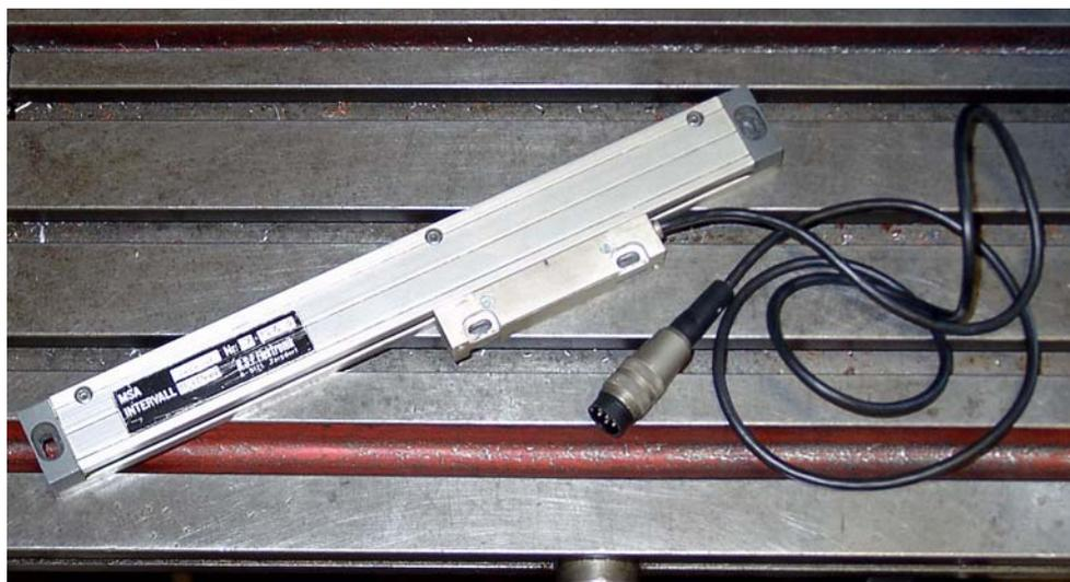
中では、エンコーダに関するケースが線で統治されて、しばしば幅10マイクロンであって、同じ大きさで分けられた空き地によって切り離されたガラス(または、時々プラスチック)片である。判決で光トランジスタを照らす光は図4-16のAとして見せられた形式に関する信号を発生させる。完了している1サイクルは20マイクロンの動きに対応している。
