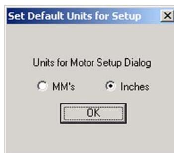
あなたが列車(例えば、ballscrewピッチ)が作られたあなたのドライブと同じシステムを選ぶならば、軸の構成のための計算はわずかに簡単になる。0.2インチのリード(5tpi)があるねじはミリメートルよりインチで構成しやすい。同様に、2mmのリードねじはミリメートルで構成しやすいようになる。さもないと、あなたは、軸の構成をするとき、1台のシステムからもう片方まで変換するために25.4が増えるか、または割る必要がある。25.4の乗法か除法が難しいが、それはただ考える他の何かである。ここでどのオプションを選んでも、あなたは、ユニットを使用することで部品プログラムを動かすことができる。
