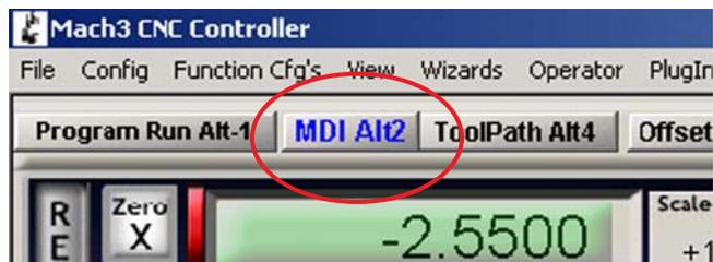
Input箱(図5-17)とインチ単位と絶対座標を選択する入りコマンド(G20 G90)ではクリックする。
