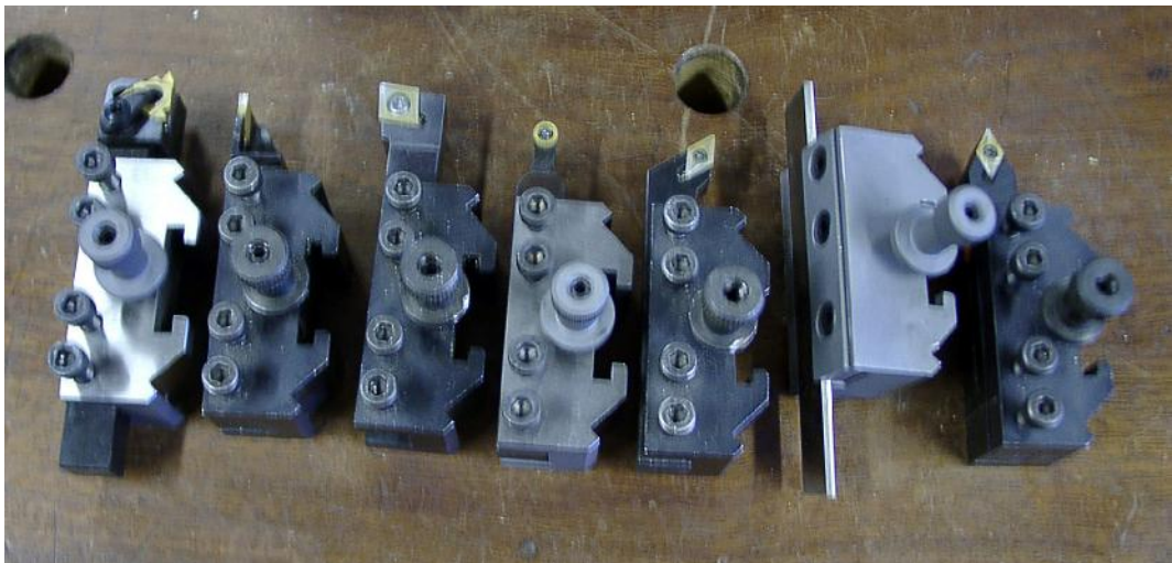
図7.6--いくつかのディックソン・システム工具ホルダ
